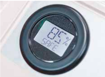
Display om accuniveau en machinestatus te monitoren
